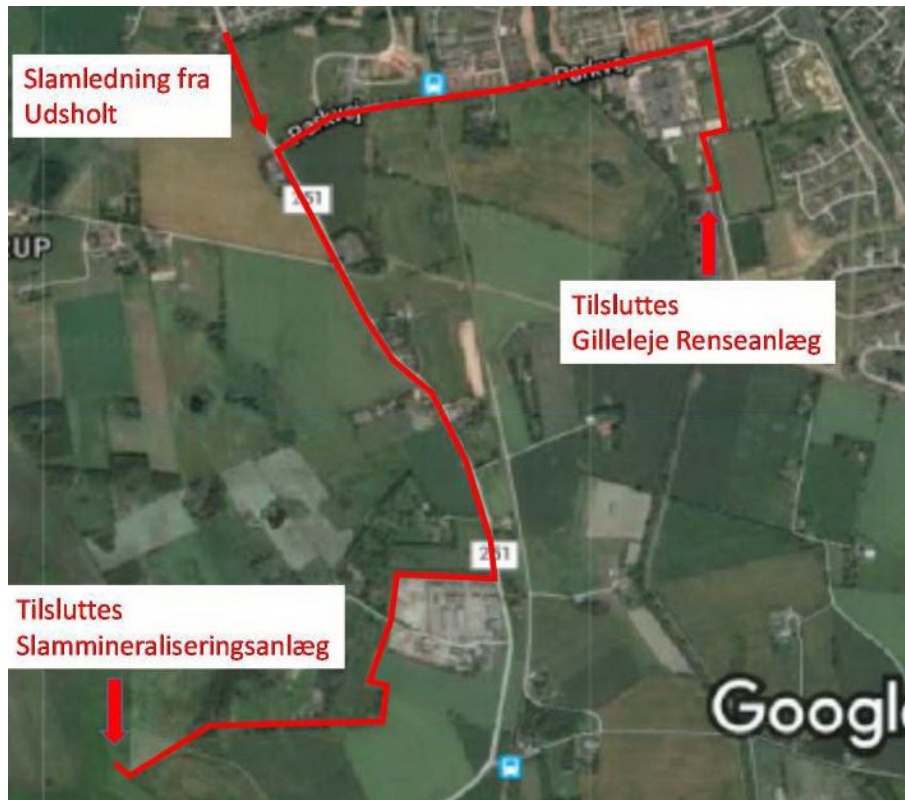
Figur 2 Placering af slamledning fra Gilleleje Renseanlæg til slamminaliseringsanlægget og rejektvandsledning fra slamminaliseringsanlægget til Parkvej. Endvidere er vist tilslutningspunktet for slamledningen fra Udsholt Renseanlæg (se figur 3).
